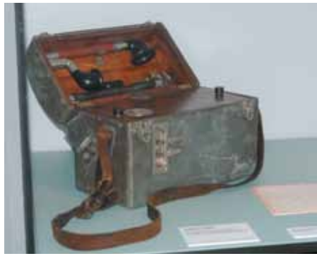
Das erste "Handy" der Welt: tragbares Telefon um 1916, gebaut um Luftschiffen im Ballonkorb unterwegs durch die Lüfte Kontakt zur Bodenstelle zu ermöglichen (Technikmuseum Berlin)
